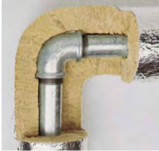
**Фот. 413.1.** Каждый цилиндр можно сделать эластичнее в произвольно выбранном месте без нарушения наружной облицовки и без необходимости разрезания на коленные сегменты. Это облегчает и значительно ускоряет монтаж изоляции, особенно на трубопроводах со сложной конфигурацией, находящейся в труднодоступных местах.
